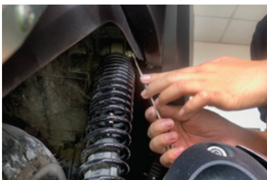
1. ชันหูใช้ค็อพด้านบนออกโดยใช้ประแจเบอร์ 14
