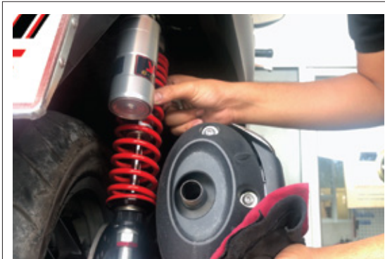
1. ติดตั้งโช้คอัพ YSS โดยให้ด้านที่มีซับแทงค์หันไป ด้านท้ายของตัวรถ
