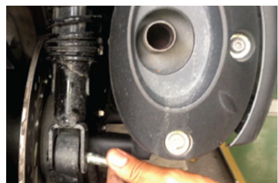
2. ใช้สล็อกเบอร์ 14 ชันหูใช้ค็อพด้านล่างออก
