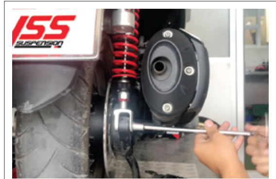
2. ชนหูล่างโช้คอัพออกด้วยบล็อกเบอร์ 14
